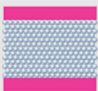
Konstellation der Vacuform® 2.0 MicroSpace Kugeln ohne Vakuum
